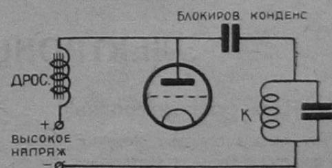
Рис. 5. Применение конденсатора для блокировки.
